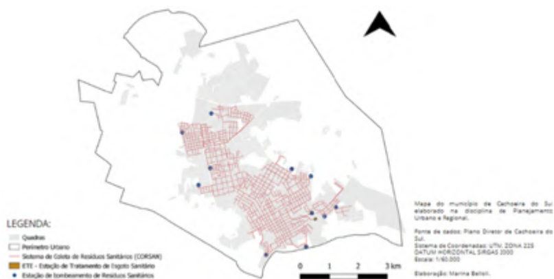
Figura 25 - Rede de esgoto sanitário na cidade de Cachoeira do Sul
